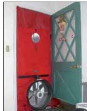
Figura 3.11. Pruebas de infiltraciones.
