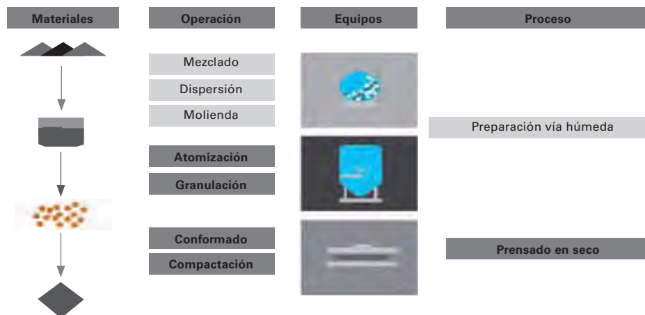
Figura 26.2. Detalle de etapas de tratamiento de materias primas y conformación en seco.
